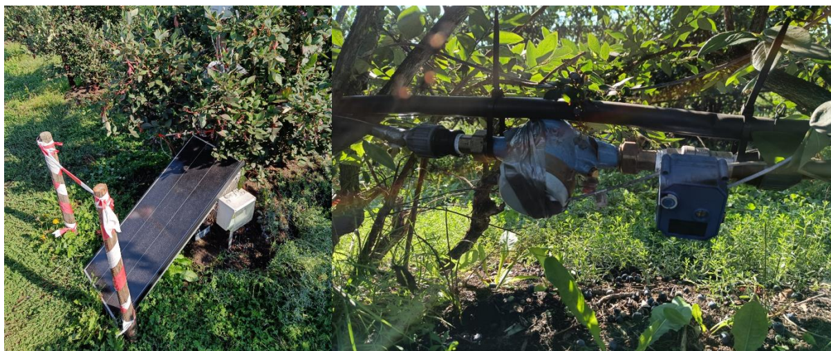
Figuur 10. Hardware voor automatische sturing van de irrigatie op het blauwe bessenperceel te Oudsbergen. Links: Crudeon Reporter met relaismodule en extern zonnepaneel/batterijsysteem. Rechts: waterteller en elektrische kogelkraan op de irrigatiedarm.
