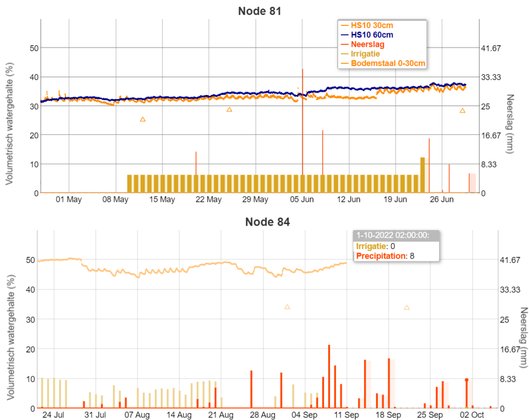
Figuur B. 38. Resultaten van twee 10HS-sensoren (node 81, boven) en TEROS-12-sensor (node 84, onder) op 25 cm diepte, vergeleken met het bodemvochtgehalte gemeten d.m.v. bodemstalen, voor het blauwe bessenperceel te Oudsbergen in 2022.
