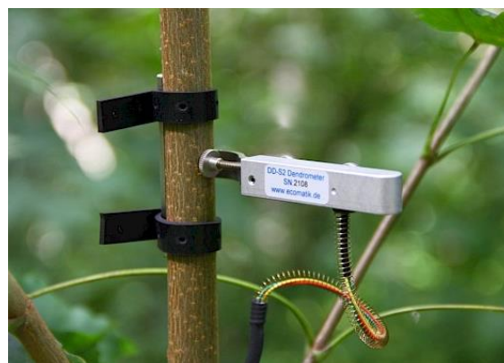
Figuur 2. Dendrometer Ecomatic DDS-2, in gebruik op demonstratiepercelen 8 en 9.
