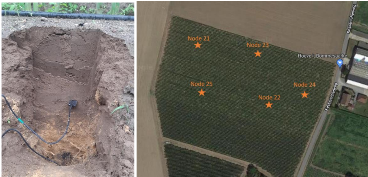
Figuur B. 7. Plaatsing van de sensoren op het aspergeperceel te Kinrooi in de diepte (links) en verspreid over het perceel (rechts).
