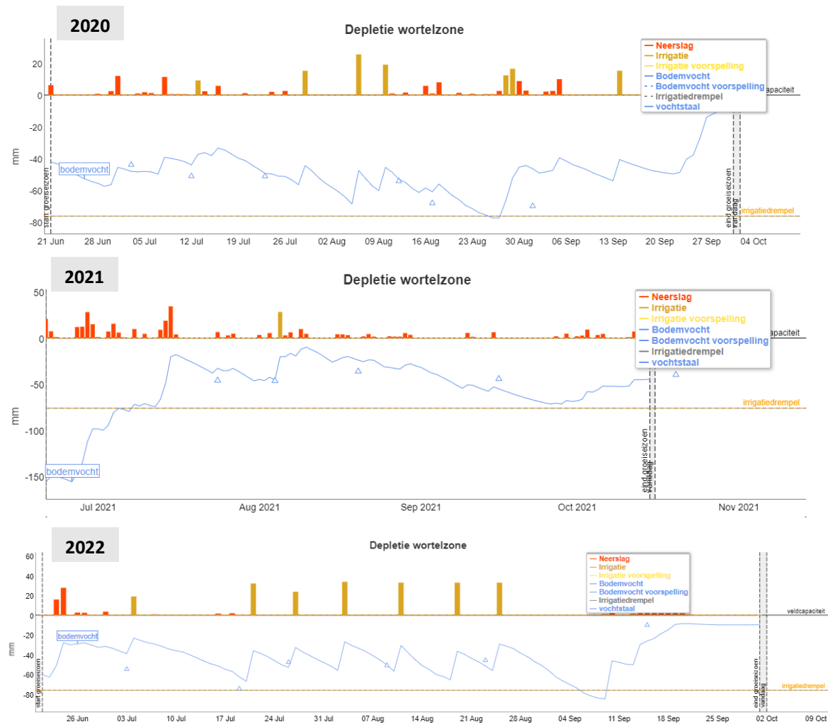
Figuur B. 10. Simulatie van het bodemvocht in de wortelzone (blauw) vergeleken met bodemstalen (driehoekjes) voor het aspergeperceel te Kinrooi in 2020, 2021 en 2022.
