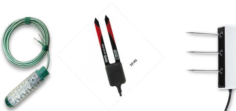
Figuur 1. Drie types bodemvochtsensoren werden uitgetest op de demonstratiepercelen en uitgelezen door de sensornodes. Van links naar rechts: Watermark, 10HS en TEROS-12.
