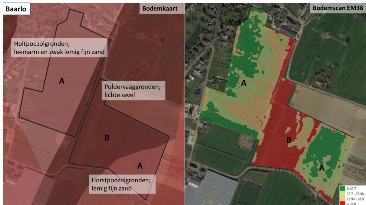
Figuur B. 5. Bodemkaart (links) en bodemscan (rechts) voor het proefperceel te Baarlo. De bodemkaart geeft drie verschillende bodemtypes weer die vnl. verschillen in textuur en dus vochthuishouding. De bodemscan weerspiegelt deze verschillen: door de lichtere, drogere bodem hebben de zones A een lagere EC dan zone B. De exacte ligging van de EC-zones komt grotendeels overeen met de bodemkaart.
