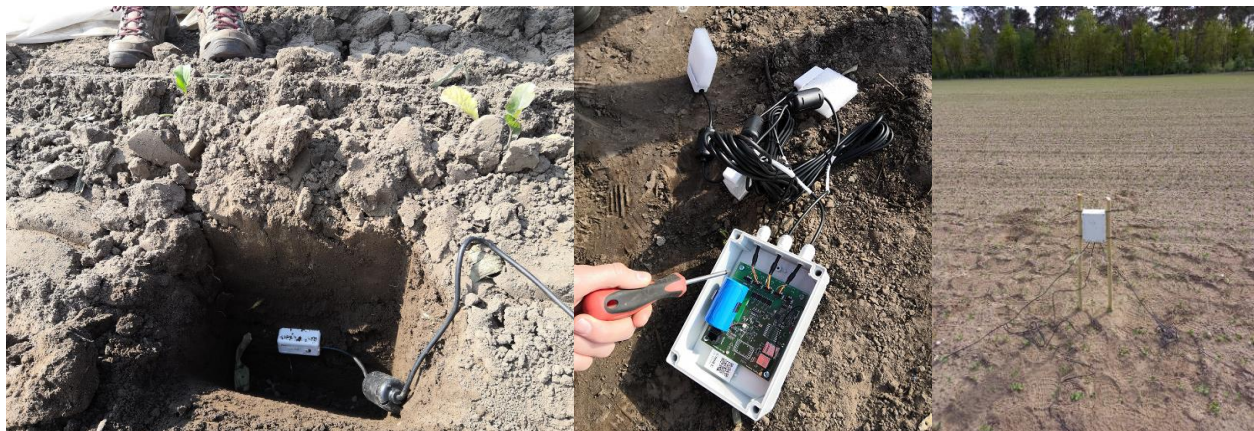
Figuur 1. Foto van de drie bodemsensoren die verbonden worden met een communicatiemodule. De module zendt de bodemvochtdata door naar een platform waar de teler deze kan raadplegen.
