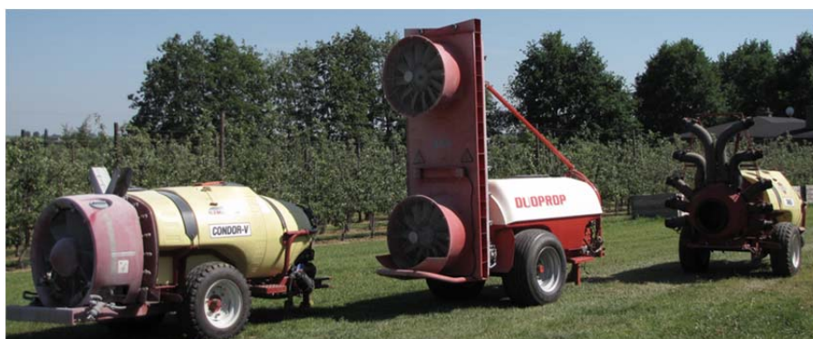
Figuur 1: Verschillende boomgaardspuiten opgenomen in het project. Van links naar rechts een axiale spuit, een dwarsstroomspuit en een boomgaardspuit met blaasmonden
