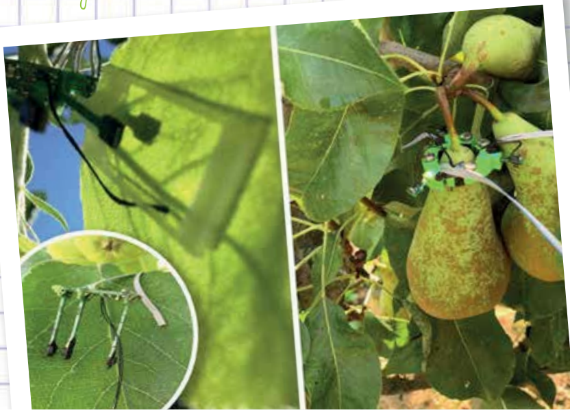
Microklimaatsensor geïnstalleerd op een blad (links) en een vrucht (rechts)
