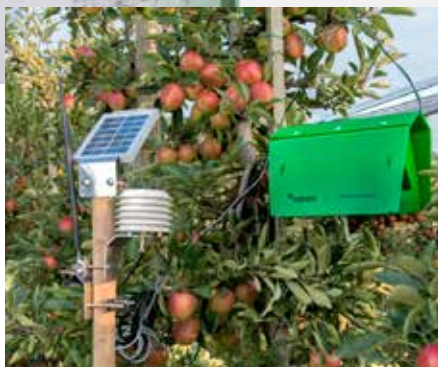
Foto 1b. – Trapview val (rechts) met basis weerstation en zonnepaneel voor elektriciteitsvoorziening in appelboomgaard.
