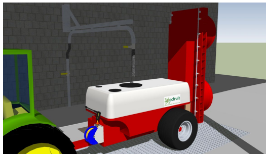
Figuur 47. Principe van galgsysteem voor het vullen van water in de spuittank in de fruitteelt
