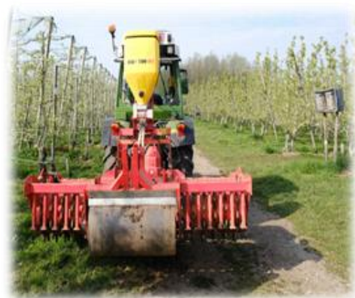
Figuur 27. – Omgebouwde rotores voor het zaaiklaar maken en zaaien van een sandwichstrook van bloemen (Verhemeldonck Y.).
