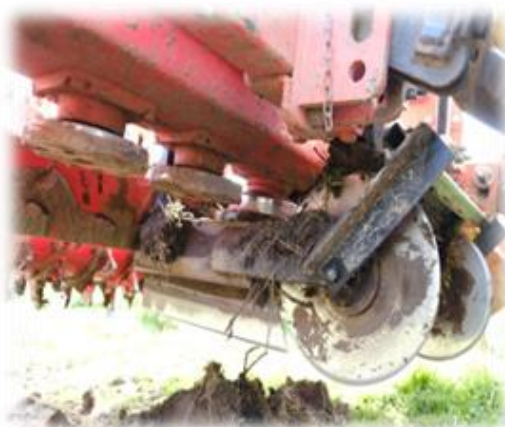
Figuur 28. – Zicht op de schijven van de sandwichstrookenzaaiër. De 2 tijdens de omvorming niet verwijderde rotorbeitels zitten erachter verscholen.
