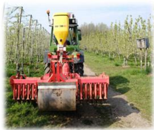
Figuur 27. – Omgebouwde rotoeg voor het zaaiklaar maken en zaaien van een sandwichstrook van bloemen (Verhemeldonck Y.).
