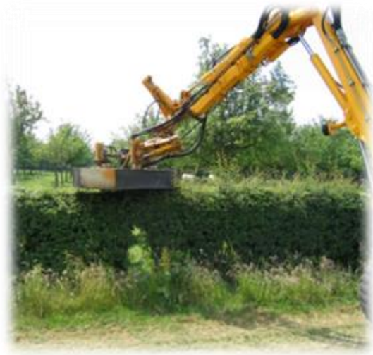
Figuur 25. – Snoeien van een haag met maaibalk.
