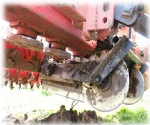
Figuur 28. – Zicht op de schijven van de sandwichstrookenzaaiër. De 2 tijdens de omvorming niet verwijderde rotorbeitels zitten erachter verscholen.
