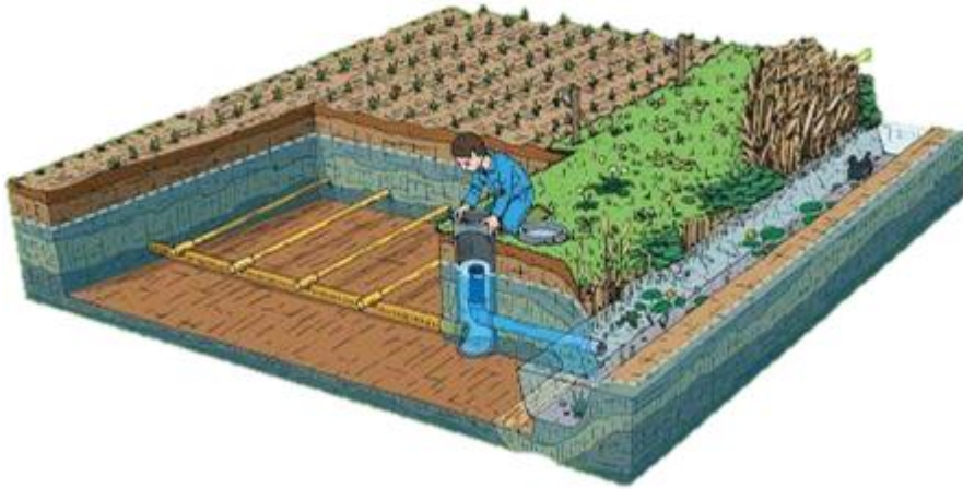
Figuur 44. – Veldsituatie bij peilgestuurde drainage
