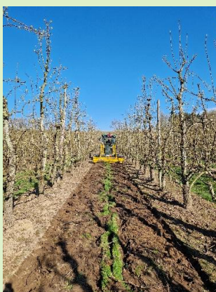
Figuur 2 Grasstrook heringezaaid met een rotores met geprofileerde lat en aangedreven aandrukrol, met zijdelangse schelpen (Induma).
