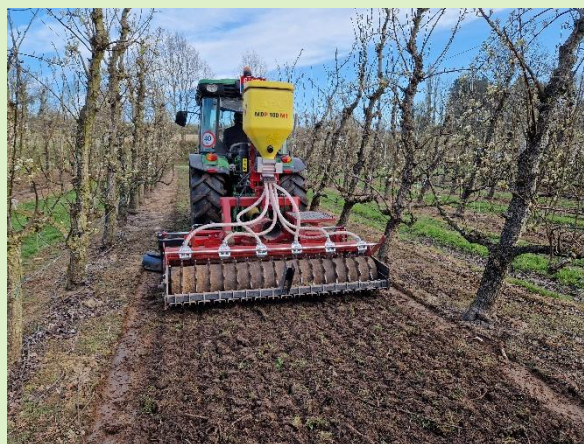
Figuur 4 Grasstrook heringezaaid met een rotores met geprofileerde lat, messen om de compactie te doorbreken, en schelpen aan de zijkant en in het midden.
