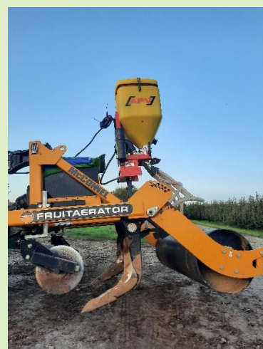
Figuur 1 Fruitaerator: Deze machine trekt de sporen op door middel van trillende woeltanden, om ook in moeilijke omstandigheden de compactie in de bovenste 20 cm te doorbreken (trilfunctie om trekweerstand te verlagen).
