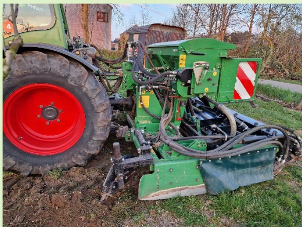
Figuur 2 Grasstrook heringezaaid met een rotores met geprofileerde lat en aangedreven aandrukrol, met zijdelangse schelpen (Induma).
