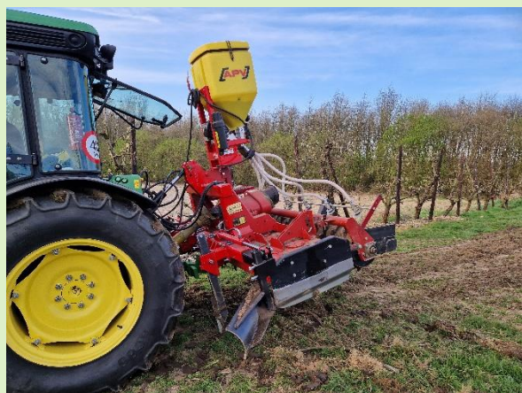
Figuur 4 Grasstrook heringezaaid met een rotores met geprofileerde lat, messen om de compactie te doorbreken, en schelpen aan de zijkant en in het midden.
