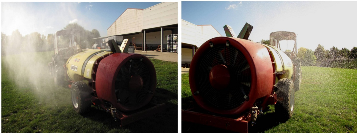
Figuur 2: Klassieke doppen genereren een fijne nevelwolk (links). Met luchtmengwerveldoppen is er minder kans op drift (rechts).
