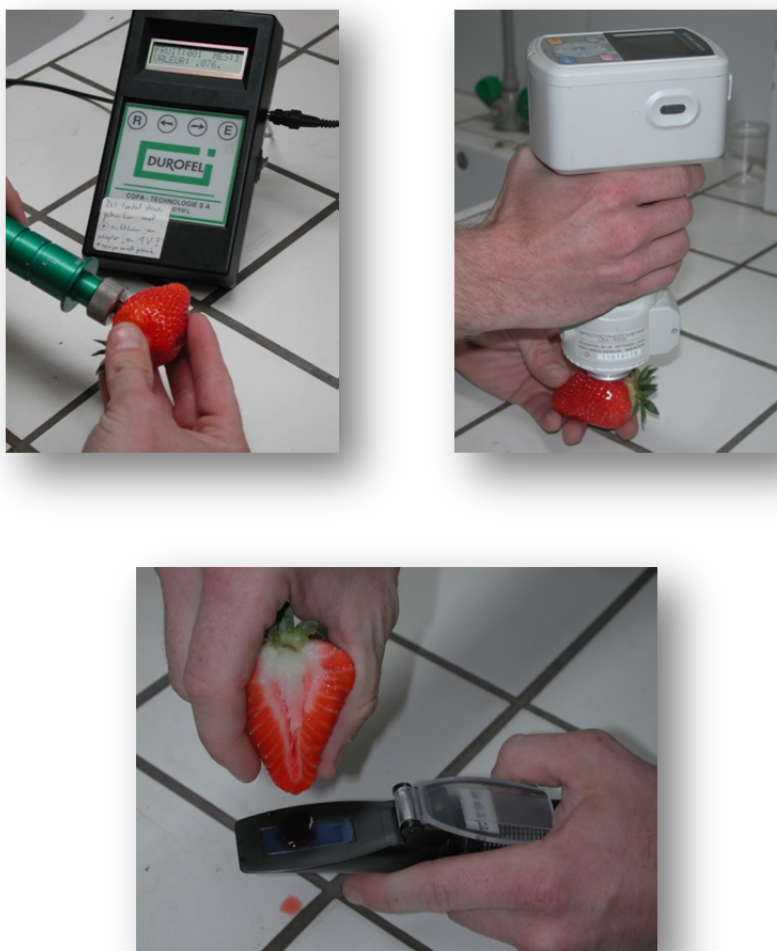
Figuur 1: Stevigheidsmeting, kleurmeting en meting van het opgelostestofgehalte bij aardbei
