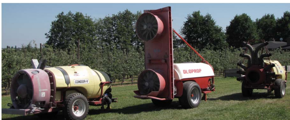
Figuur 1: Verschillende boomgaardspuiten opgenomen in het project. Van links naar rechts een axiale spuit, een dwarsstroomspuit en een boomgaardspuit met blaasmonden
