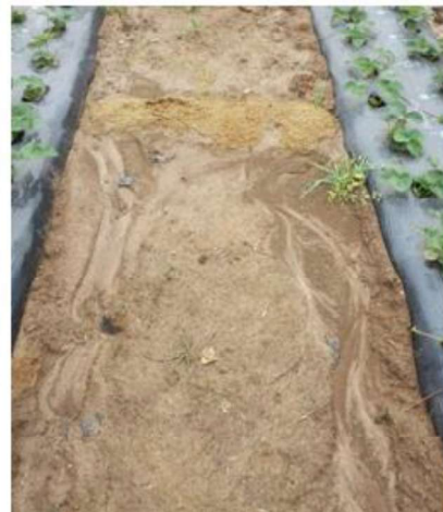
Figuur 7 Erosiemulch zwelt initieel goed op, maar verdwijnt na 2 maanden.
