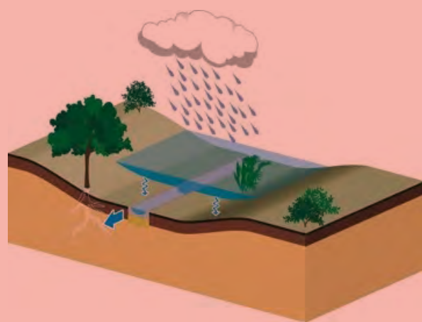
FIGUUR 1 Infiltratietechnieken, zoals een wadi, zorgen voor een duurzaam waterbeheer waarbij hemelwater in de grond infiltreert. (bron : Architecture & Climat)
