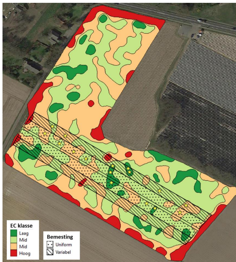
Figuur 2. Kaart van proefperceel “Perez” met aanduiding van de verschillende EC-klassen. De sterren duiden de ligging van de experimentele plots aan. Het gearceerde deel werd gebruikt voor de proef, waarbij de middelste zone (puntjes) uniform en de buitenste zone (streepjes) variabel bemest werd.
