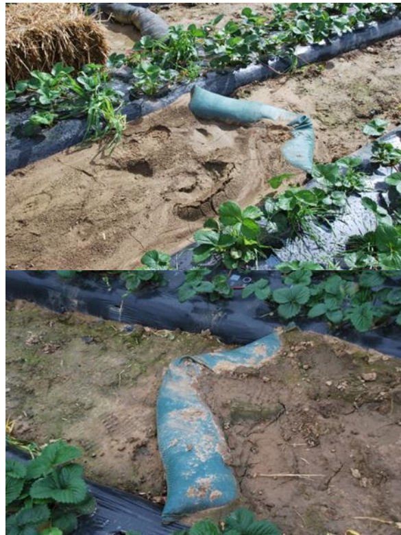
Figuur 6 Het slib hoopt zich duidelijk op voor de zand-, steen- en kiezelzakjes. Ook het regenwater wordt zichtbaar tegengehouden.
