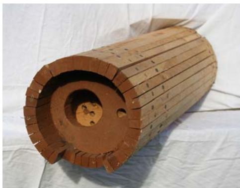
Buisvorm, moet nog omwikkeld worden met teerdoek of vijverfolie detail op sluis
