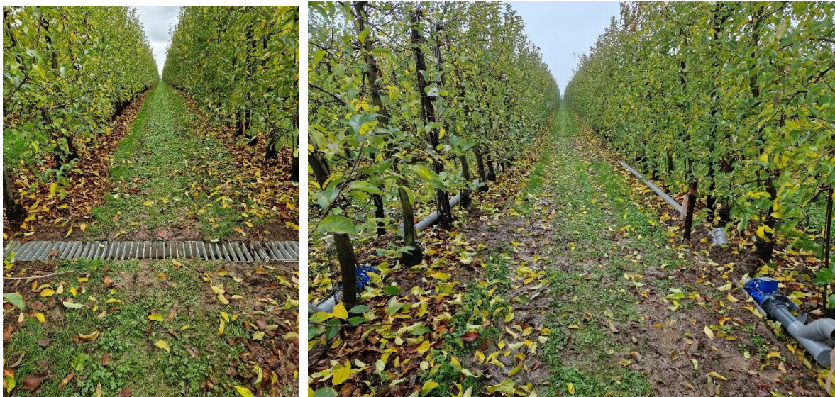
Figuur 1 Proefopstelling om runoff te meten: rooster aangebracht in een grasstrook (links), waarin runoff wordt opvangen en afgeleid naar een ultrasone watermeter die lager opgesteld staat (rechts).
