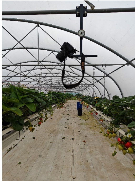
Figuur 7: Vaste camera opstelling op pefruit voor bepaling van de occlusiefactor in camerabeelden van doordrager aardbeien op stelling in een tunnel.
